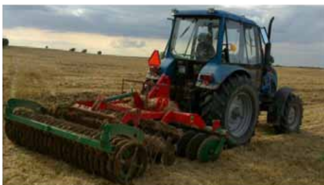
Fig. 1. Post-harvest tillage with the use of a disc harrow. Rys. 1. Uprawa późniwna broną talerzową.
