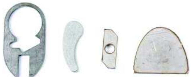
Rys. 4. Detale płaskie wycinane laserem
