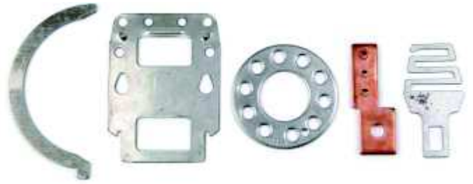
Rys. 1. Płaskie detale wycinane z blachy przy użyciu prasy
