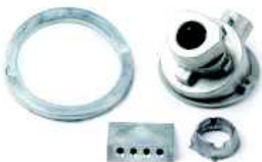
Rys. 8. Odlewy ciśnieniowe obrabiane przy użyciu luźnych kształtek
