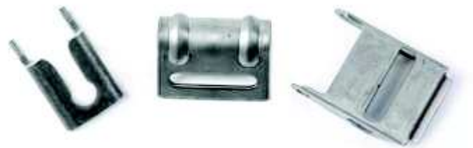
Rys. 2. Detale stalowe wycinanie i formowane przy użyciu prasy
