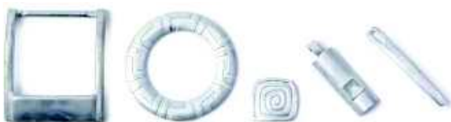
Rys. 9. Odlewy wytwarzane w odlewarkach odśrodkowych
