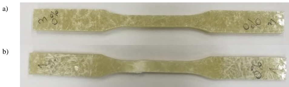
Rys. 2. Widok próbek wykorzystanych w badaniach: a) przed testem, b) po teście
