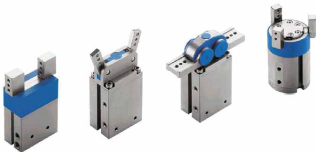
Rys. 4. Chwytaki standardowe firmy FESTO: od lewej HGP – chwytak równoległy; HGW – chwytak kątowy; HGR – chwytak promieniowy; HGD – chwytak trójszczękowy (Źródło: FESTO)
