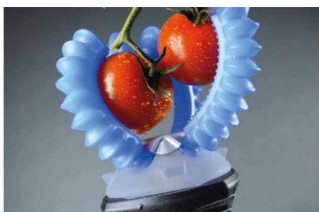
Rys. 9. Chwytnak z końcówkami elastycznymi (Źródło: Soft Robotics Inc.)
