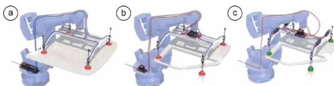
Rys. 12. Chwytnak podciśnieniowy z zespołem przyssawek: a) układ scentralizowany; b) układ częściowo zdecentralizowany; c) układ w pełni zdecentralizowany (Źródło: Pomoc środowiska Cosimir)
