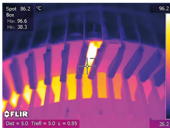
Fot. 15. Zwarcie blach żelaza czynnego przy luźnym pręcie biernym
