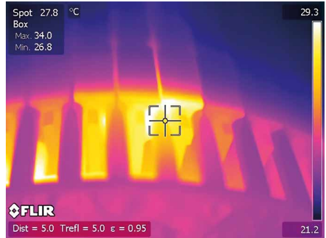
Fot. 11. Wirnik dwuklatkowy - termogram - zwarcie pręta klatki roboczej z żelazem oraz zwarcie pręta klatki rozruchowej z żelazem
