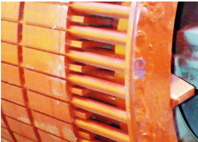
Fot. 10. Wirnik dwuklatkowy - fragment wirnika
