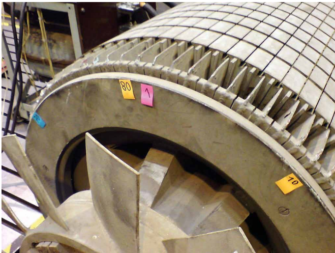
Fot. 18. Wirnik głęboko żłobkowy silnika o mocy 6,3 MW
