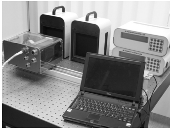
Rys. 3. Zautomatyzowane stanowisko do wyznaczania parametrów i kalibracji kamery termowizyjnej
