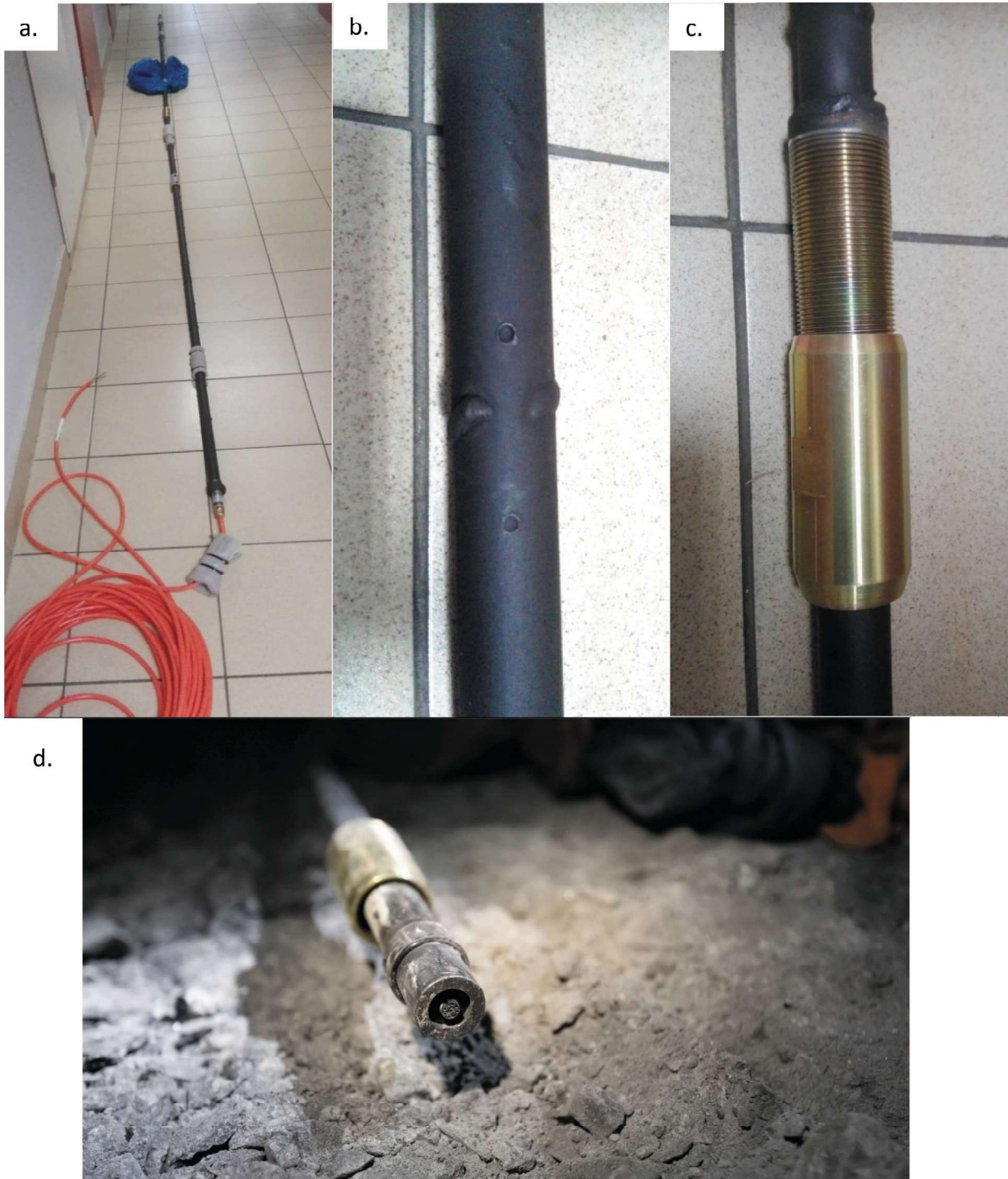
Rys. 10. Kotew pomiarowa z drgającą struną: a. widok ogólny kotwi, b. odcinek kotwi z drgającą struną, c. łącznik segmentów kotwi, d. gniazdo łączenia segmentów kotwi
