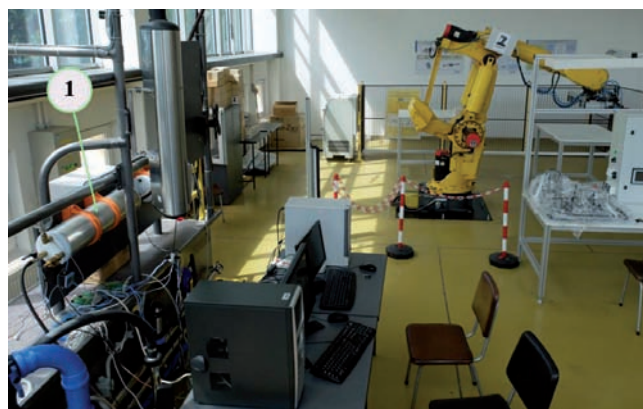
Rys. 2. Stanowisko badawcze z robotem przemysłowym FANUC S420i F Fig. 2. The test stand with industrial robot FANUC S420i F
