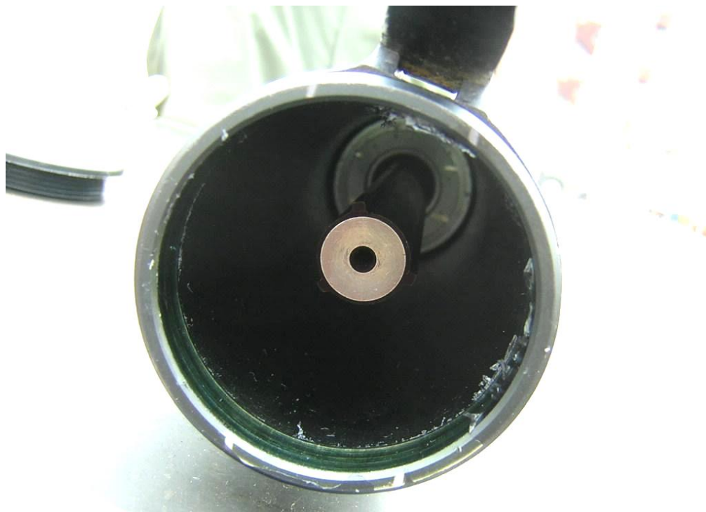
Rys. 10. Wnętrze moździerza QTL89. Widoczny pręt oporowy z otworem na iglicę [10] Fig. 10. The inside of mortar QTL89. Supporting rod with the hole for the needle is visible [10]
