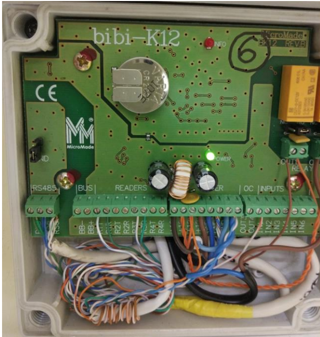
Rys. 2. Kontroler bibi-K12 [opracowanie własne autorów]
