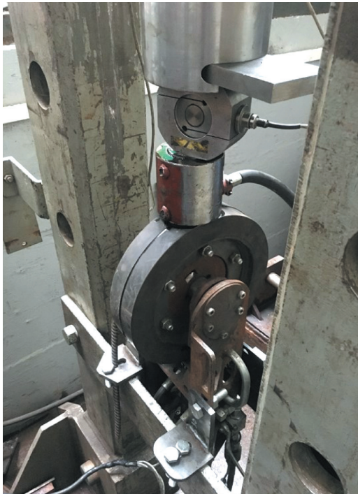
Rys. 4. Elementy dynamometru OPA-B-2018 na stanowisku badań ITG KOMAG
