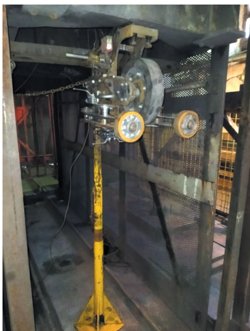
Rys. 2. Konstrukcja urządzenia pomiarowego zabudowanego w naczyniu wyciągowym
