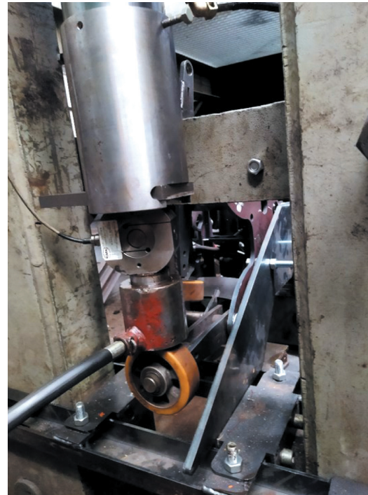
Rys. 4. Elementy dynamometru OPA-B-2018 na stanowisku badań ITG KOMAG
