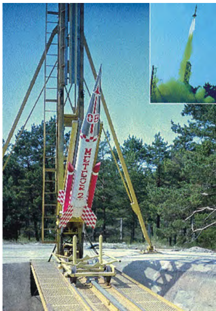
Rys. 2. Rakieta „Meteor-2” konstrukcji Instytutu Lotnictwa (maksymalny pułap około 105 km)
