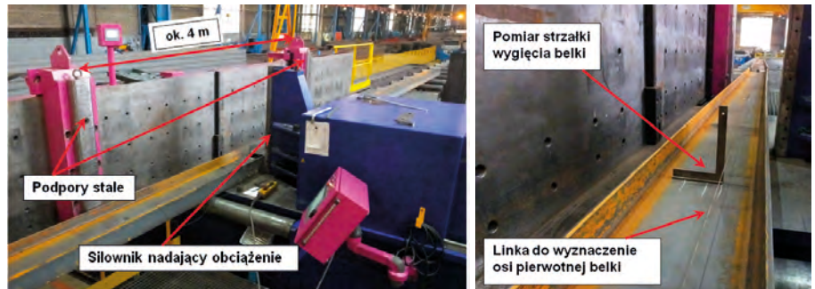
Fot. 1. Punktowe gięcie na zimno. a) maszyna do punktowego gięcia na zimno belek, b) pomiar wygięcia (zdjęcia autora)
