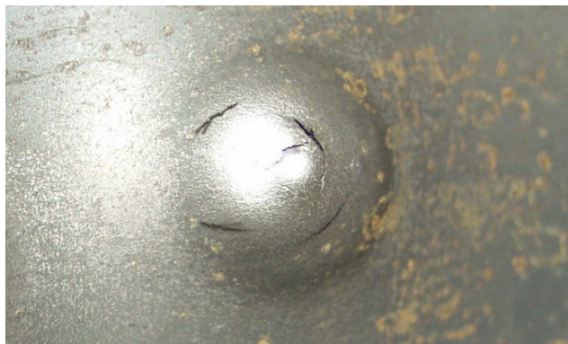
Fot. 3. Widok spękaną i odkształconą płytę po uderzeniu pocisku w wersji W1z – niepełna penetracja stosu płyt stalowych o grubości 16 mm (4+4+4+4 mm)
