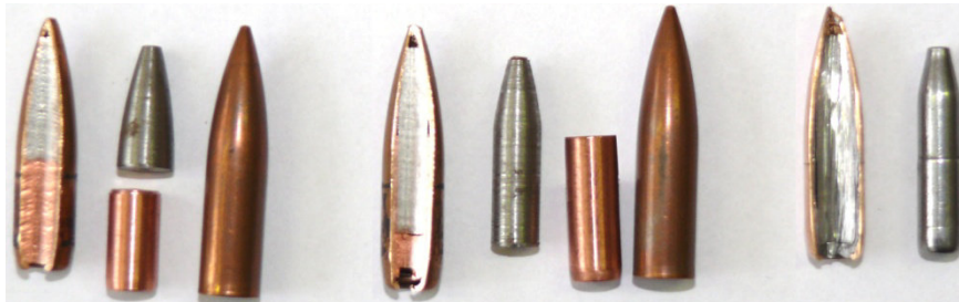
Fot. 1. Opracowane pociski w przekroju oraz ich elementy składowe; od lewej: pocisk w wersji W1z, pocisk w wersji W2z i pocisk W2M
