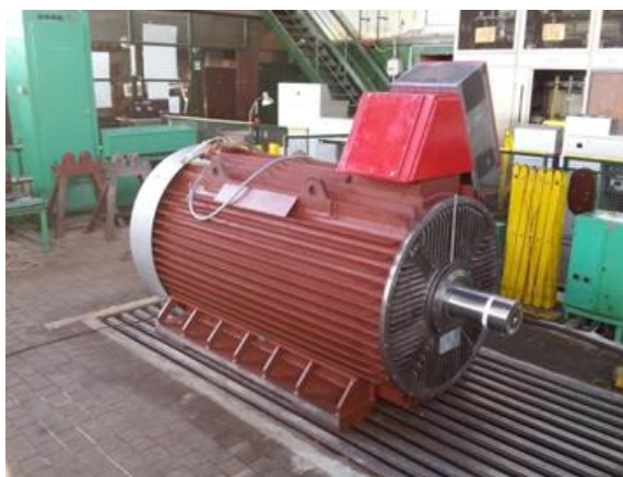
Rys 2. Prototypowy model silnika LSPMSM (SI 560X-4Apm): podczas montażu (a), na stacji prób (b)
