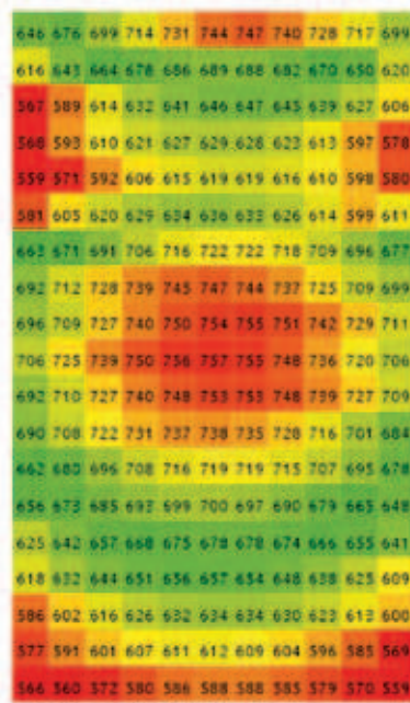
Rys. 5, 6 i 7. Przykładowe rozkłady natężenia promieniowania słonecznego na powierzchni obejmującej badane próbki – zróżnicowana siatka pomiarowa natężenia i odmienny kąt padania promieniowania
