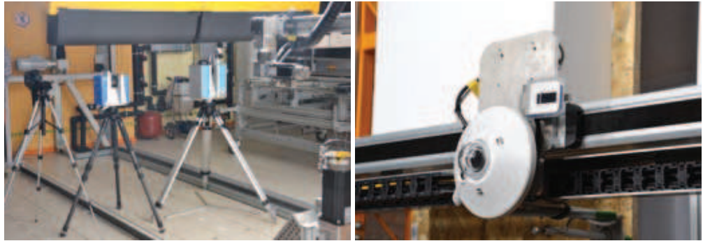
Rys. 3 i 4. Wykorzystane w badaniach – kamera termowizyjna Flir E95, Skaner 3D Z+F IMAGER 5016 (po lewej) oraz Z+F IMAGER 5010 (po prawej), ruchomy pyrometr
