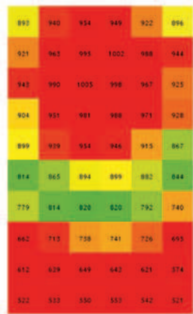
Rys. 5, 6 i 7. Przykładowe rozkłady natężenia promieniowania słonecznego na powierzchni obejmującej badane próbki – zróżnicowana siatka pomiarowa natężenia i odmienny kąt padania promieniowania
