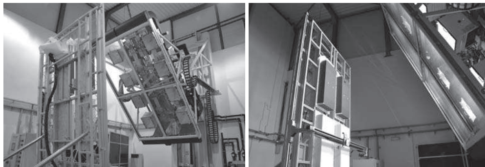
Rys. 1 i 2. Symulator promieniowania słonecznego przed pomiarami i w ich trakcie
