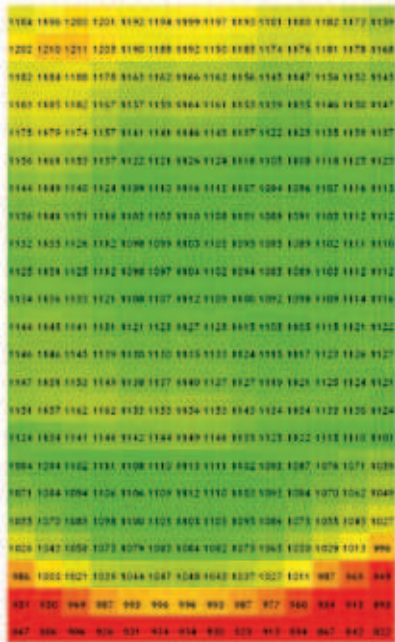
Rys. 5, 6 i 7. Przykładowe rozkłady natężenia promieniowania słonecznego na powierzchni obejmującej badane próbki – zróżnicowana siatka pomiarowa natężenia i odmienny kąt padania promieniowania
