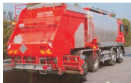
Fot. 16. Spryskiwanie środkiem konserwującym Rhinophalt® [2]
