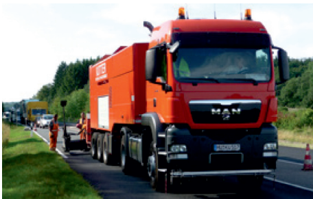
Fot. 30. Czyszczenie nawierzchni wodą pod ciśnieniem wraz z odsysaniem szlamu [2]
