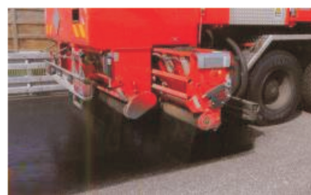
Fot. 17. Posypanie specjalnym, bardzo drobnym kruszywem łamannym (szerokość ziarna od 0,6-3,8 m) [2]
