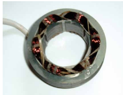
Rys. 3. Stojan silnika wentylatora z jawnymi biegunami
