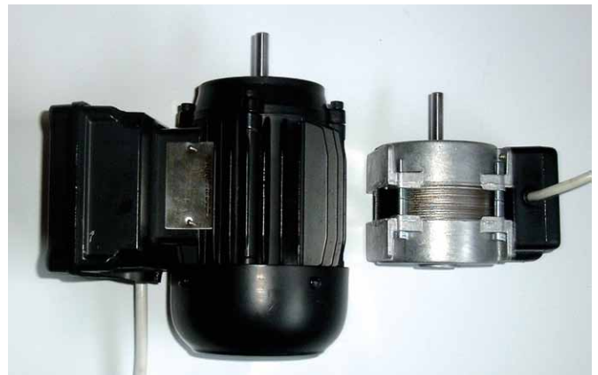
Rys. 4. Dotychczasowy i nowy silnik wentylatora
