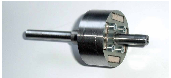
Rys. 2. Wirlnik silnika wentylatora z zagłębionymi magnesami trwałymi
