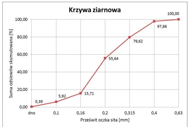
Rys. 2. Analiza sitowa i krzywa ziarnowe dla piasku chromitowego. Jaśniejszym kolorem znaczone frakcję główną
