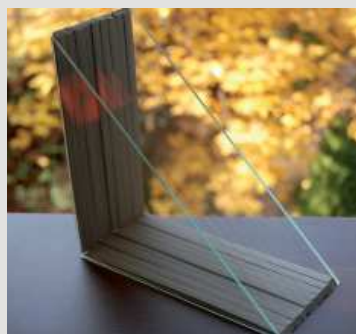
Rys. 4. Przekrój przez prototypowy zestaw szyby zespolonej o powiększonej szerokości. Widoczne podziały z ultracienkiego szkła pomiędzy szymbami zewnętrznymi [5].
