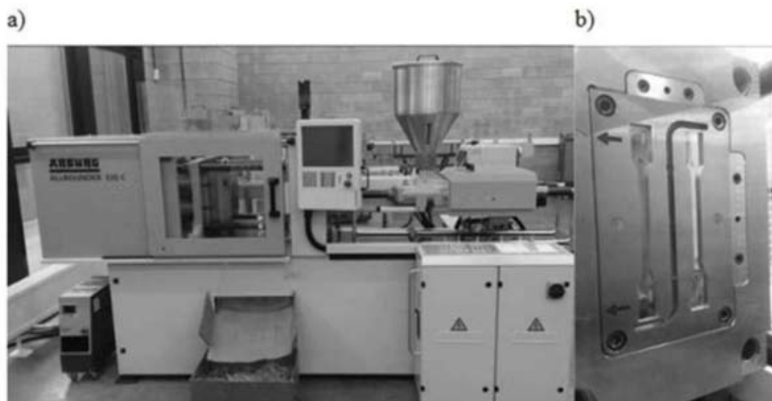
Rys. 1. Wygląd a) wtryskarki ślimakowej Arburg Allrounder 320C b) gniazda formy wtryskowej do wytwarzania próbek w kształcie wiosełek
