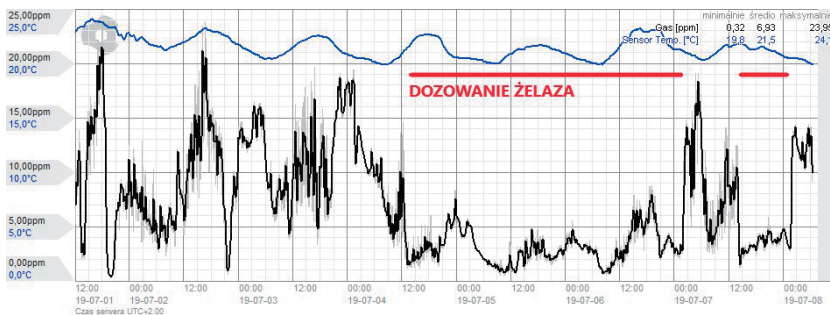
Stężenia siarkowodoru w kolektorze płaszowskim podczas testów dozowania związków żelaza, lipiec 2019 r.
