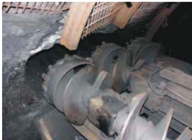
Rys. 6. Widok głowic zwiercających przy ociosie węglowym [5] Fig. 6. View of drilling heads by the coal sidewall [5]
