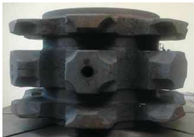
Rys. 2. Obiekt badań – bęben łańcuchowy wysoko wydajnego ścianowego przenośnika zgrzeblowego RYBNIK 850
