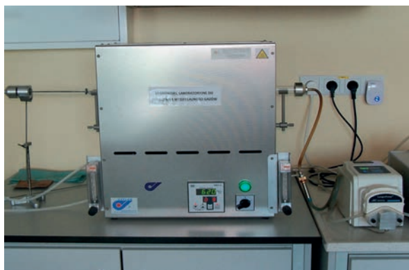
Rys. 3. Stanowisko pomiarowe do termicznego rozkładu spoiw odlewniczych (fot. własna)
