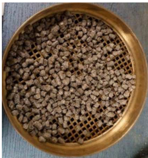
Rys. 13: Uzyskane pelety z Cannabis sativa L.
