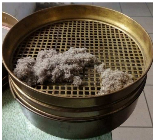
Rys. 12: "Kłęby" powstałe po rozdrobieniu Cannabis sativa L.
