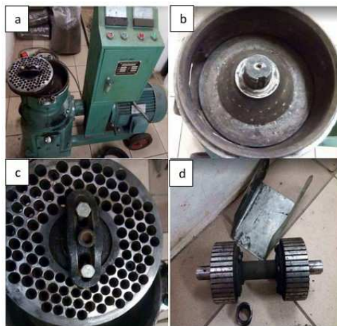
Rys. 3: Peleciarka WKL300B-TP podczas konserwacji: a) peleciarka ze zdemontowaną górną częścią komory roboczej, z odkręconą matrycą, b) komora robocza z trzpieniem montażowym matrycy, c) matryca z elementem montażowym, d) wałek z rolkami dociskającymi i zsymp pelętów
