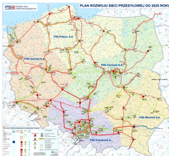
Rys. 3. Plan sieci elektroenergetycznej NN [5] - kolorem zielonym zaznaczono linie 220 kV, zaś czerwonym 400 kV
