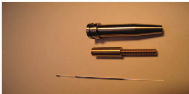
Rysunek 7 Zdjęcia dysz i kapilar stosowanych do formowania laminarnego strumienia wodnego i wprowadzania wiązki laserowej
