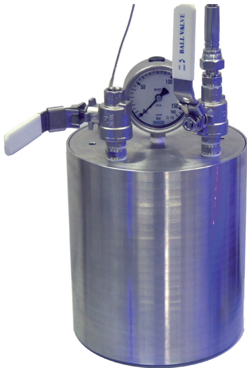
Rysunek 5 Zdjęcie zbiornika ciśnieniowego z cieczą roboczą (wodą) wraz z zaworami i manometrem
