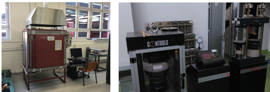
Rys. 3. Stanowisko do badania próbek w podwyższonych temperaturach (po lewej) oraz stanowisko do badania wytrzymałości na ściskanie
