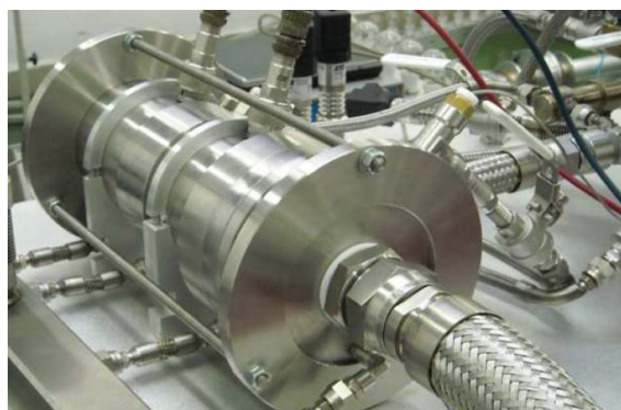
Rys. 2. Mikroturbogenerator o mocy 2,5 kW
