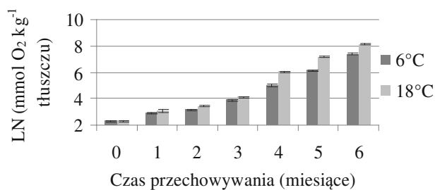
Rysunek 1. Zmiany liczby nadtlenkowej oleju rzepakowego Figure 1. Changes of the peroxide number of rapeseed oil
