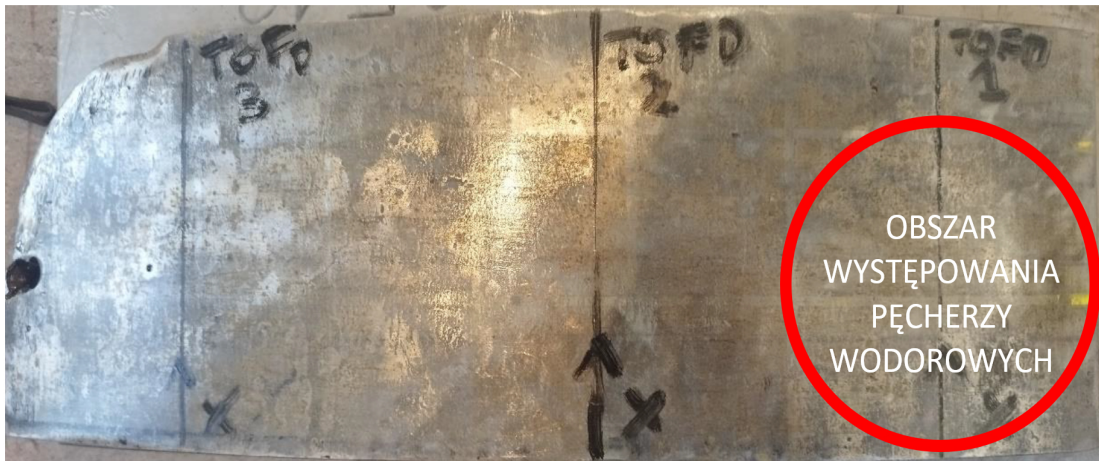
Rys. 7. Miejsca wykonania skanów TOFD na badanym wycinku; TOFD 3 (95 mm na OY), TOFD 2 (240 mm na OY), TOFD 1 (351 mm na OY). Strzałkami zaznaczono kierunek przejazdu skanera w OX (początek OX – punkt 0 – krawędź wycinka)
