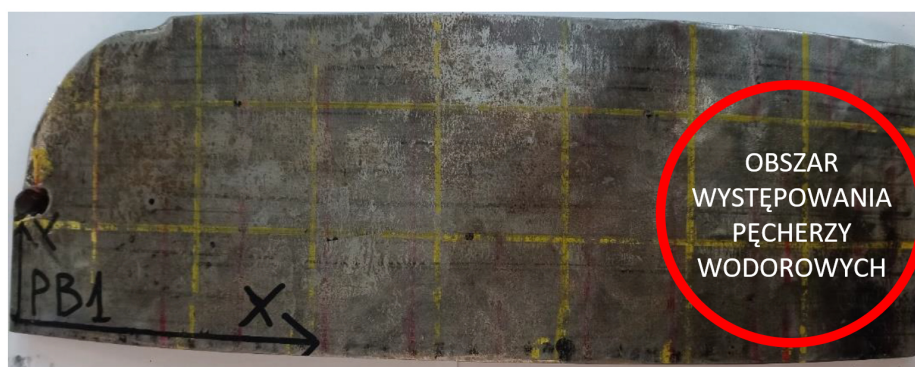
Rys. 3. Schemat badania wycinka z zaznaczonym układem odniesienia
