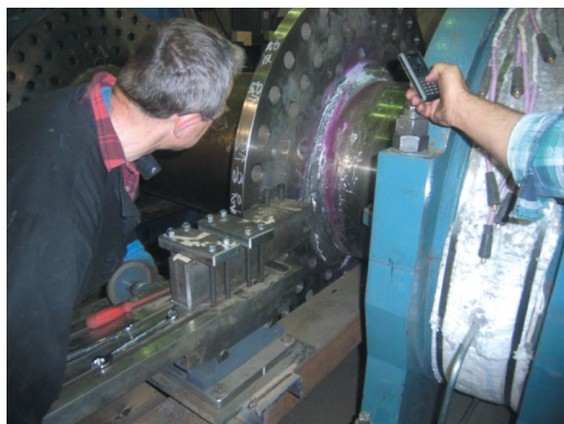
Rys. 9. Obróbka wału po spawaniu w celu nadania fragmentowi wału odpowiedniego promienia krzywizny [1]
