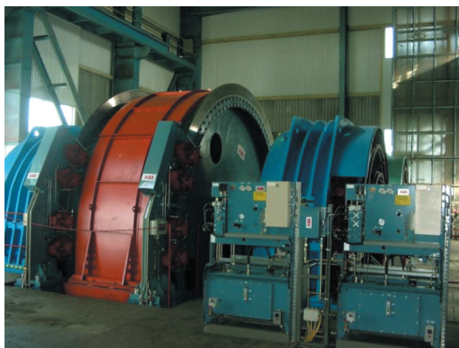
Rys. 1. Widok maszyny wyciągowej w przedziale (S) szybu R-II po modernizacji w 2004 r. [1]
