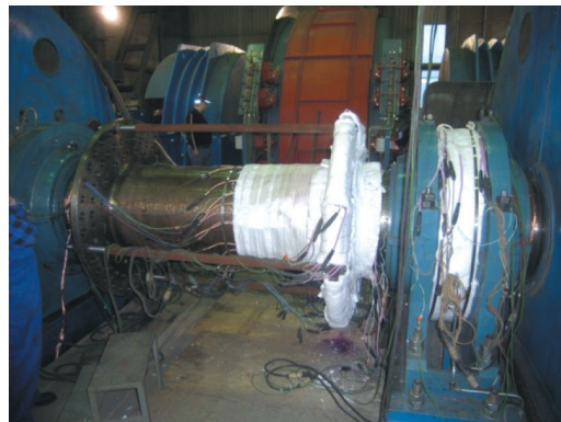
Rys. 6. Obszar wokół miejsca spawania został odizolowany, a następnie podgrzany za pomocą nagrzewarki oporowej oraz mat grzewczych; prędkość nagrzewania wynosiła około 25^{\circ}\text{C} na godzinę [1]
