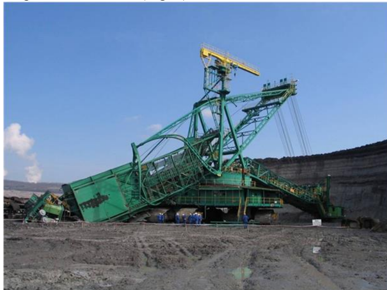
Fig. 2 Katastrofalne skutki pęknięcia zmęczeniowego [37]
