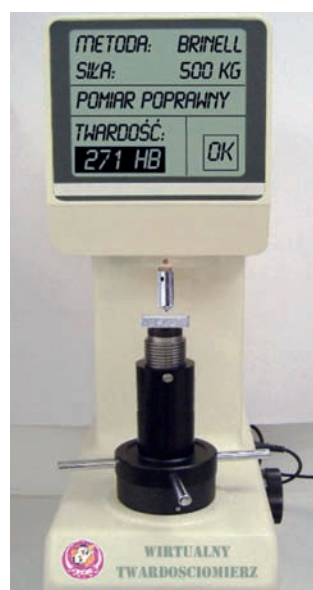
Rys. 5. Wirtualny uniwersalny twardościomierz AEDT. Wynik pomiaru
