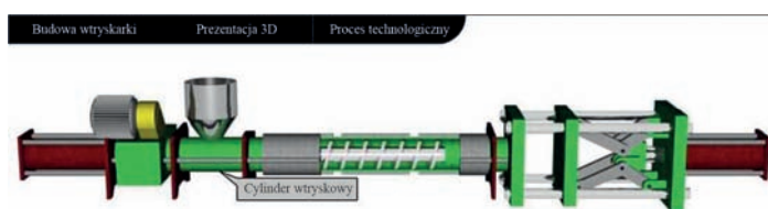
Rys. 10. Okno symulacji przedstawiające budowę wtryskarki
