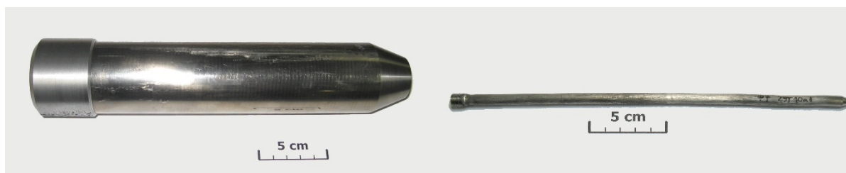
Rys. 2. Wsad Ø50 mm przygotowany do wyciskania, Proces nr 4
