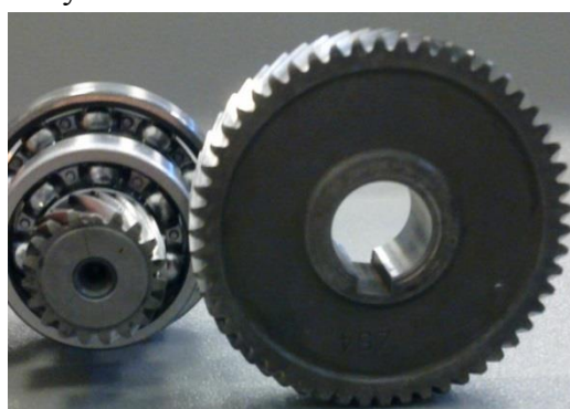
Rys.12. Widok badanych próbek walcowych kół zębatych o zębach skośnych – przekładnia nr 3 (tab. 5)
