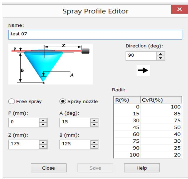
Fig. 4. Spout geometric parameters entry dialog box
