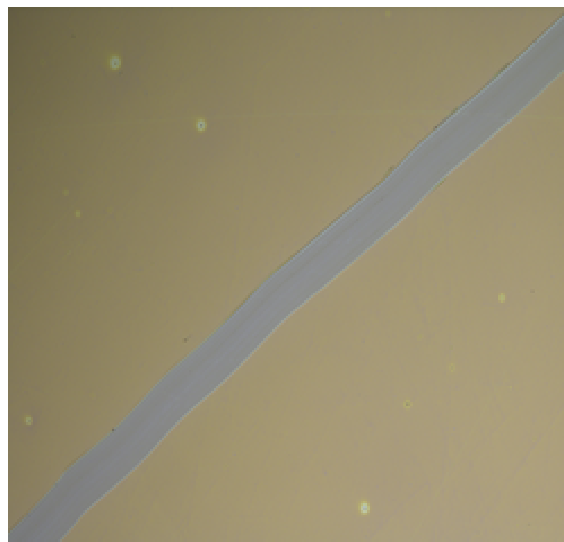
Rys. 1. Próbką FOFu z naniesioną warstwą organiczną oraz wykonaną rysą
