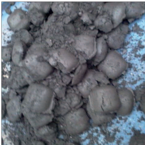
Rys. 4. Brykiety ze spoiwem na bazie skrobi modyfikowanej
