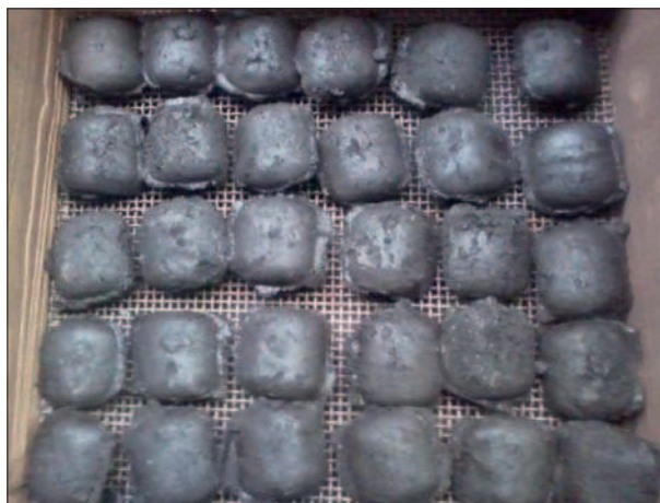
Rys. 5. Brykiety ze spoiwem na bazie wapna hydratyzowanego i melasy
