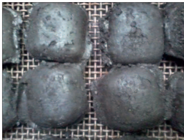
Rys. 4. Brykiety ze spoiwem na bazie skrobi modyfikowanej
