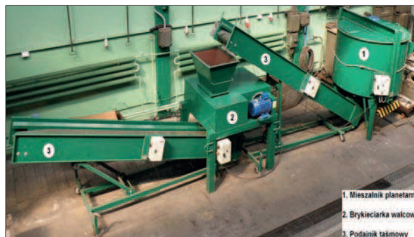
Rys. 1. Laboratoryjna instalacja do brykietowania z prasą walcową
