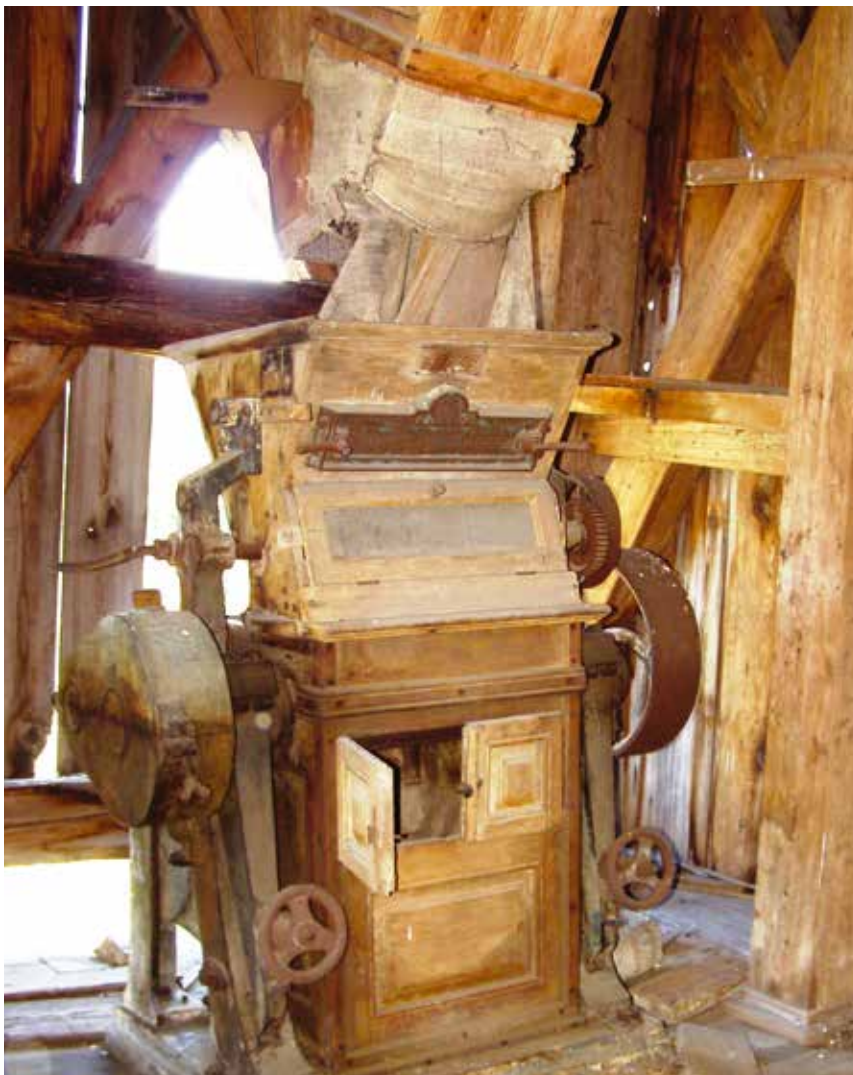
Fot. 6. Młewnik walcowy Ganz'a w wiatraku koźlaku w m. Linin, gm. Góra Kalwaria; źródło: fot. F. Tomaszewski, październik 2021 r.
