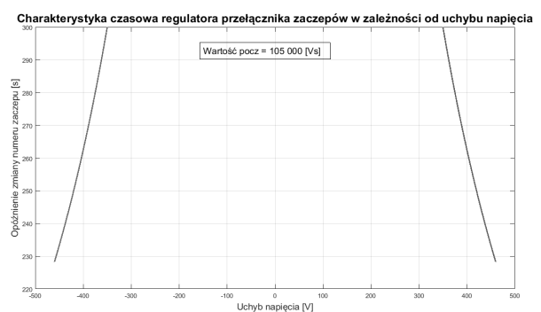
Rys. 6. Charakterystyka czasowa regulatora przełącznika zacze- pów w zależności od uchybu napięcia
