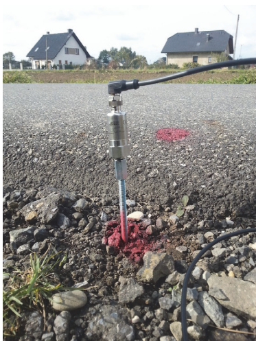
Rys. 3. Posadowienie czujnika w poboczu na metrowym pręcie gwintowanym
