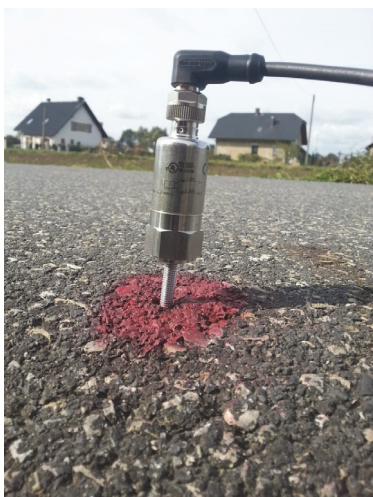
Rys. 2. Posadowienie czujnika na małej głębokości w asfalcie
