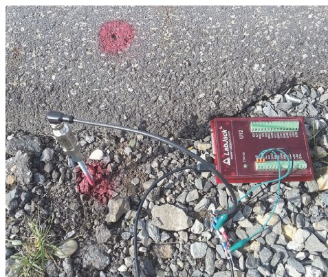
Rys. 1. Stanowisko pomiarowe z zaznaczonymi czerwoną farbą miejscami posadowienia czujnika
