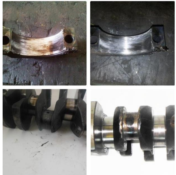
Rys. 4. Elementy układu korbowego silnika uszkodzone na skutek niedostatecznego smarowania powierzchni kontaktowych w węzłach kinematycznych [14].
