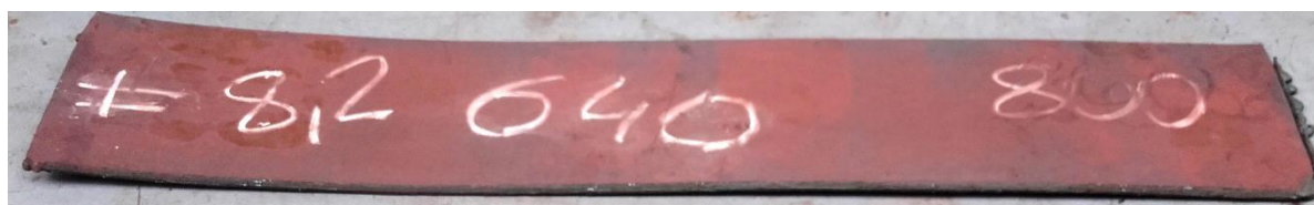
Rys. 2. Fotografia płaskownika o grubości nominalnej 8 mm ze stali nanostrukturalnej
