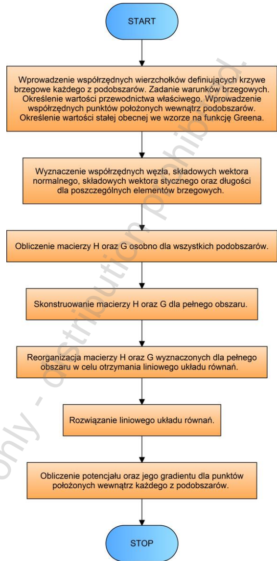
Rys. 3. Schemat blokowy wykonanej implementacji MEB
