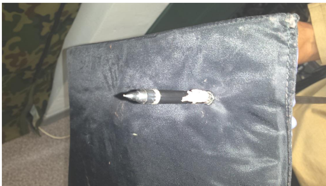
Fot. 3. Przebicie panelu balistycznego grotem ITB/2
