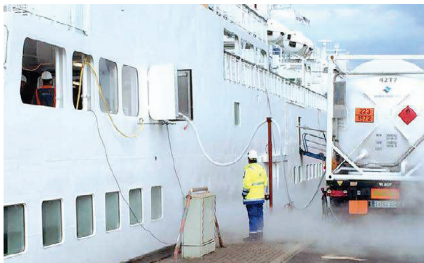
Fig. 4. Mv. Ostfriesland bunkering from LNG cistern [4]
