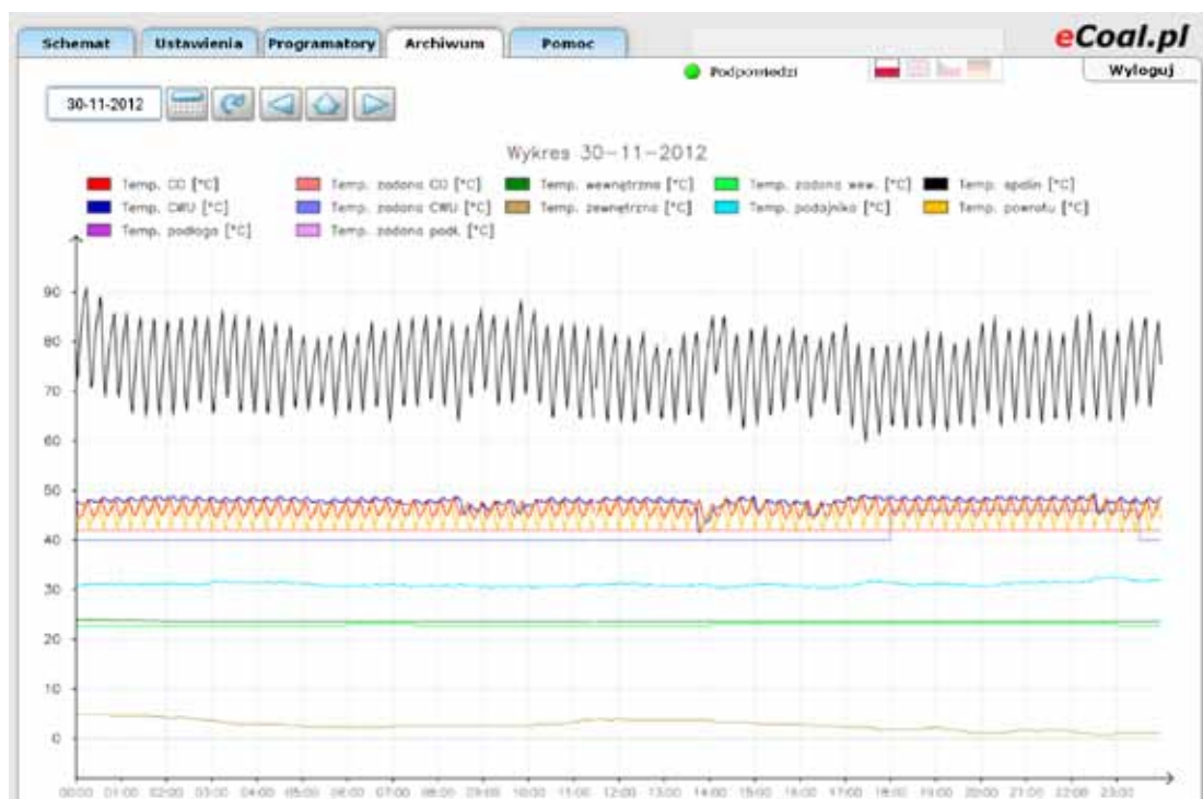
Rys. 6 Zapis parametrów pracy kotła w pamięci sterownika wygenerowany w postaci wykresów
