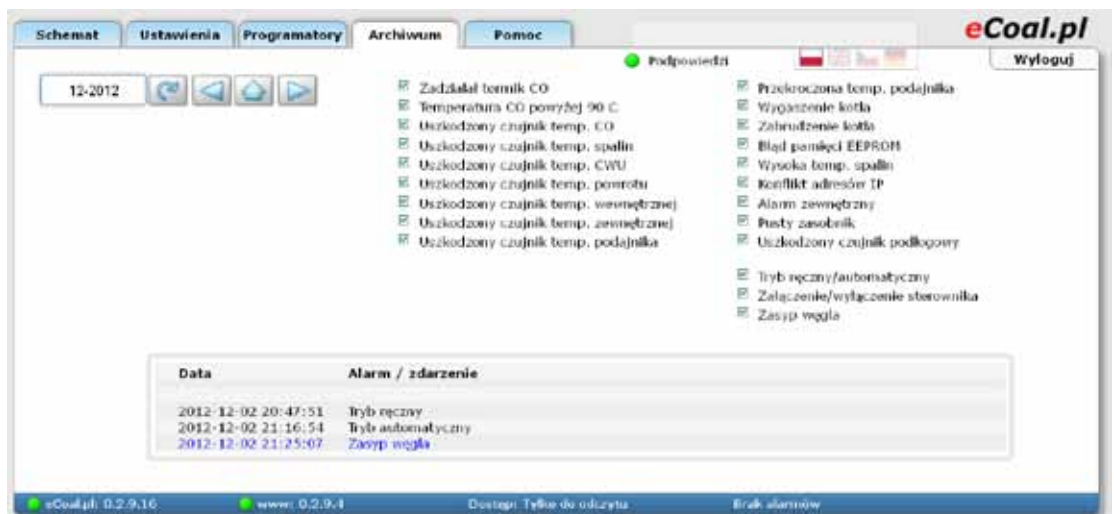
Rys. 5 Rejestr w pamięci sterownika alarmów i innych zdarzeń
