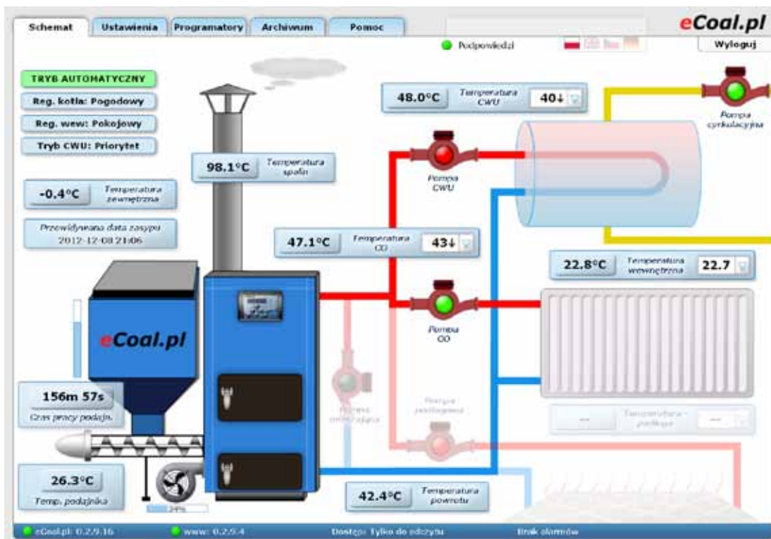
Rys. 1 Widok pracy kotła w oknie przeglądarki internetowej
