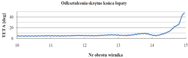
Rys. 10. Zmiana przemieszczeń skrętnych końca łopaty wirnika nośnego w zależności od azymutu dla \theta_0 = 2^\circ , C_0 = 5,2^\circ [opracowanie własne]
